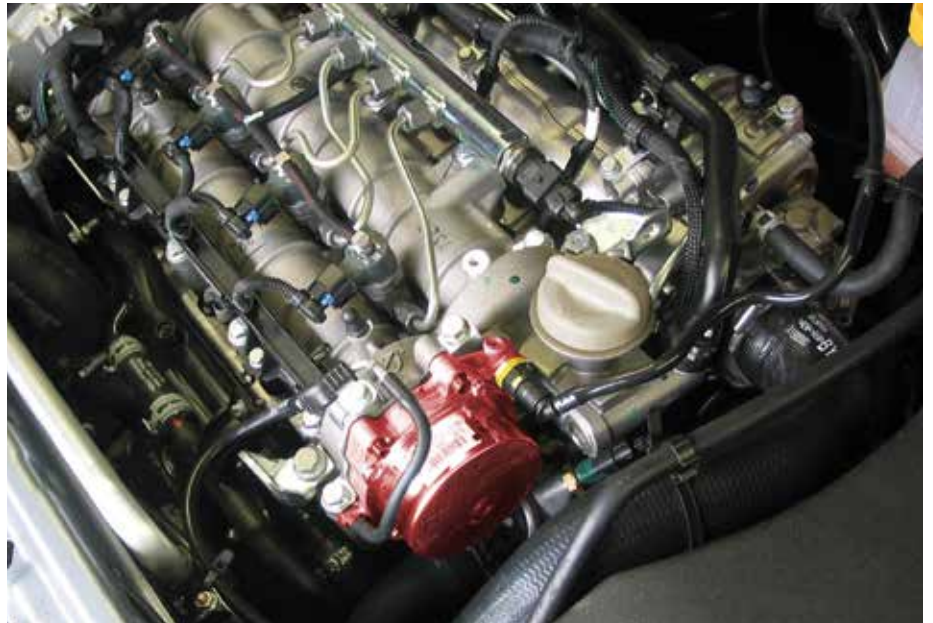
Bomba de vacío en el Opel Vectra B (resaltada)
