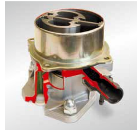
El estado actual de la técnica: bomba de vacío monopaleta (modelo en corte)
