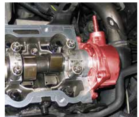
Bomba de vacío y árbol de levas en el Opel Vectra B (resaltados)
