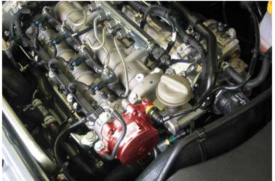
Pompe à vide installée dans une Opel Vectra B (en évidence)
