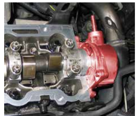
Pompe à vide et arbre à cames dans une Opel Vectra B (en évidence)
