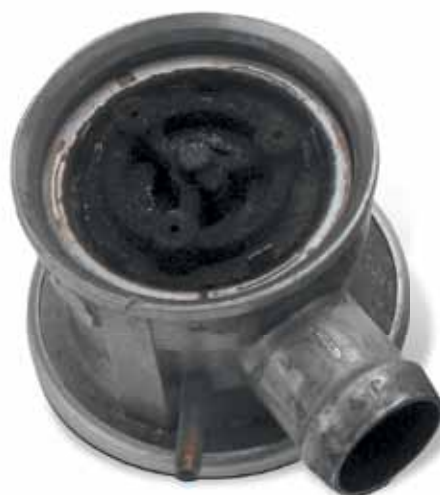
Uszkodzenie spowodowane przez skroplone spaliny
