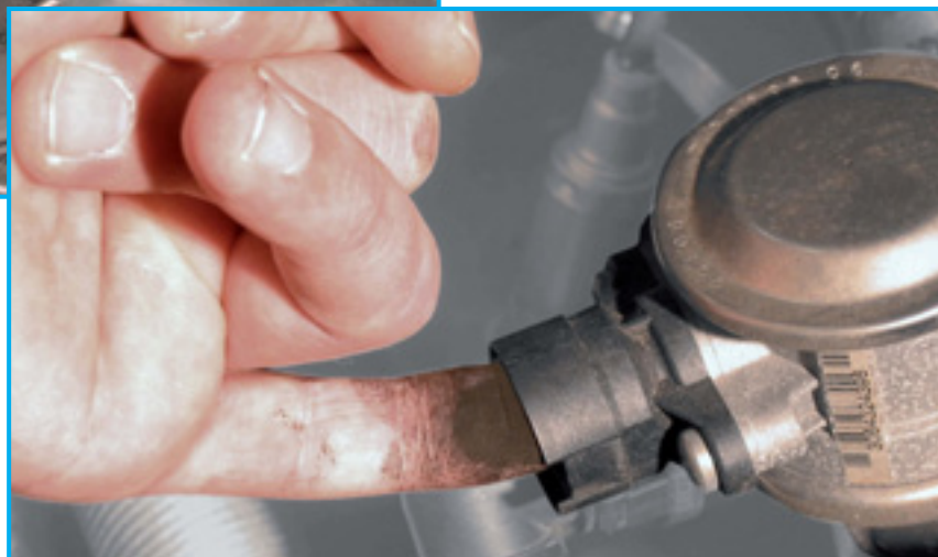
Rychlá kontrola ventilu sekundárního vzduchu na BMW 520i (zvýrazněno)
