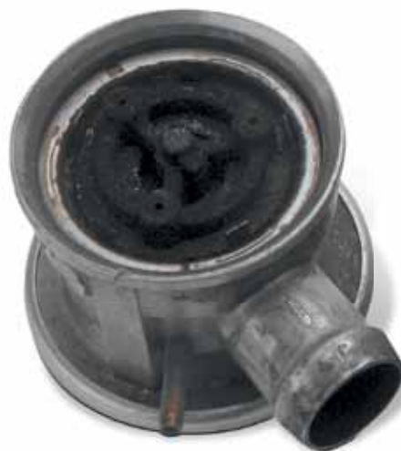
Повреждение под действием конденсата отработавших газов
