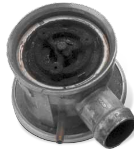
Daños por condensado de gas residual
