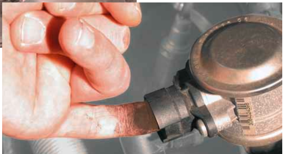
Rapide contrôle du clapet d'air secondaire dans la BMW 520i (mis en évidence)
