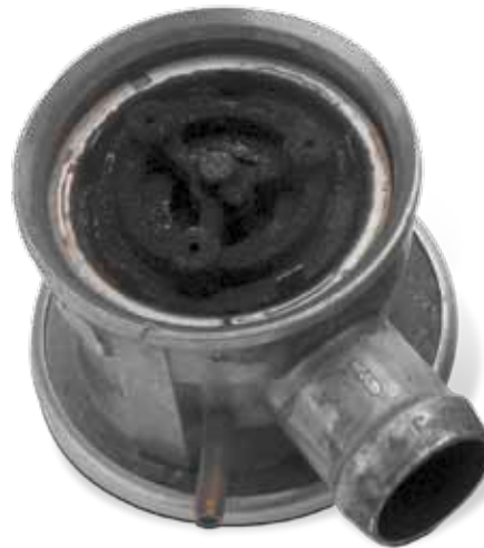
Dégâts provoqués par une condensation des gaz d'échappement
