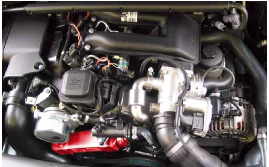
Fig. 2: radiador EGR en un BMW 318d (resaltado en rojo)
