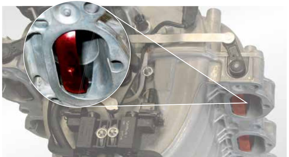
Klapy Tumble (zaznaczone na czerwono) w rurze dolotowej PIERBURG, np. w Mercedesie klasy E 500
