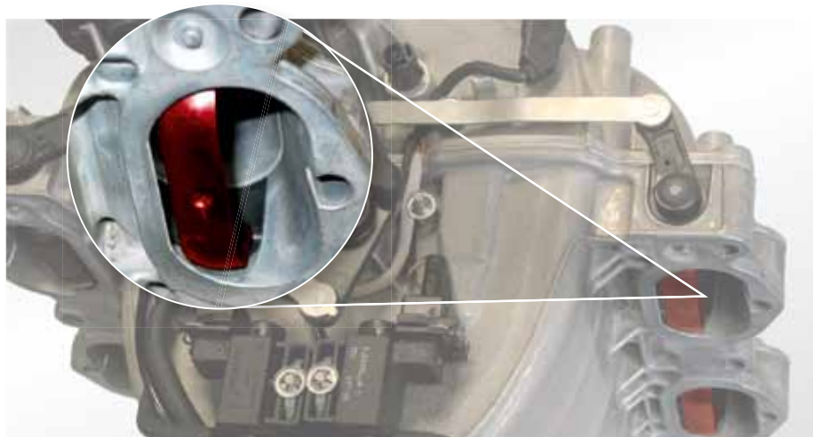
Перекидные заслонки (выделены красным цветом) во впускной трубе PIERBURG, например, в Mercedes E-класса 500
