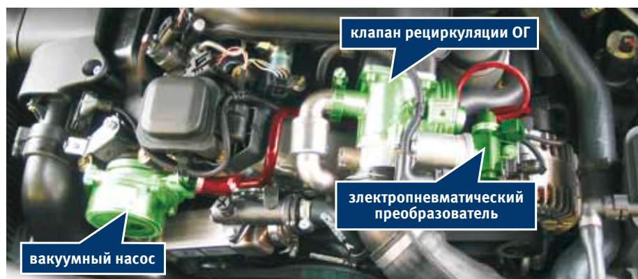
Пример BMW 118d (E87), (выделено зеленым цветом: детали в вакуумной системе, выделено красным цветом: вакуумные шланги)
