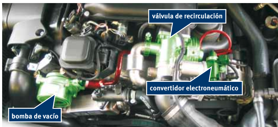
Ejemplo BMW 118d (E87), (resaltados en verde: elementos en el sistema de depresión resaltados en rojo: mangueras de depresión)
