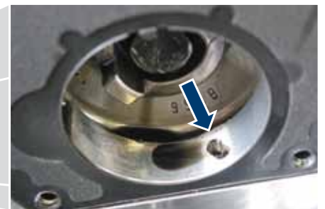
Ejemplo: en el Opel Vectra, el suministro de aceite lubricante tiene lugar a través de orificios existentes en la brida
