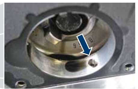
Exemple : sur l'Opel Vectra, l'huile lubrifiante est amenée par des orifices dans la bride
