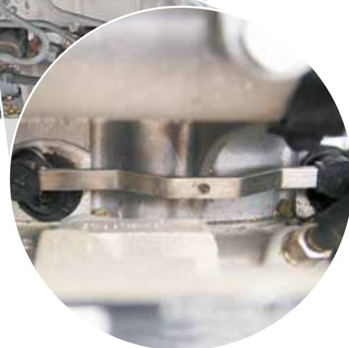
Tirante da caixa de velocidades no tubo de aspiração no Opel Vectra (destacado a vermelho em cima e com vista detalhada)
