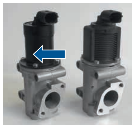
Rysunek 5: Oryginalny korpus cewki został zastąpiony zwykłą częścią obrotową (strzałka).
