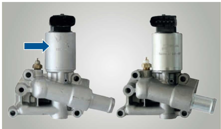
Rysunek 1: Polakierowany zawór EGR (strzałka) wygląda jak nowy – ale taki nie jest.
