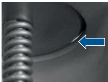
Rysunek 3: Nieszczelne gniazdo zaworu (strzałka) powoduje problemy.
