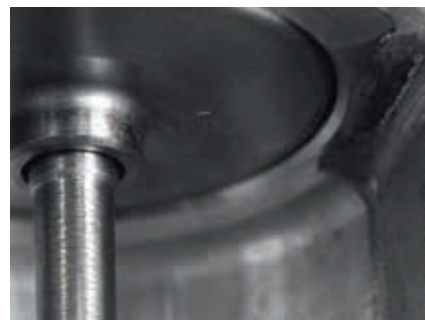
Rysunek 3: Nieszczelne gniazdo zaworu (strzałka) powoduje problemy.
