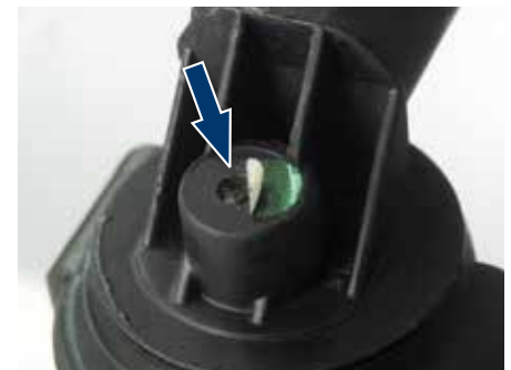
Billede 2: På grund af denne udboring (pil) kan der trænge vand ind, hvilket kan få ventilen til at svigte.
