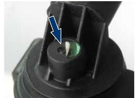
Figura 2: Esta perforación (flecha) puede permitir la entrada de agua y causar averías.
