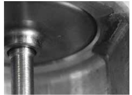
Figura 3: Un asiento de válvula no estanco (flecha) causa problemas.
