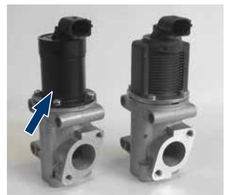
Figura 5: El cuerpo de la bobina original se sustituyó por una simple pieza giratoria (flecha).
