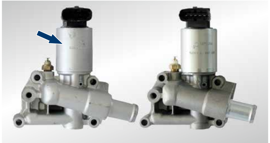
Figura 1: Una válvula EGR pintada (flecha) parece nueva - pero no lo es.
