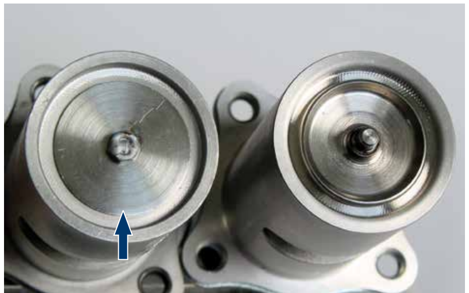
Figura 4: Un disco de latón soldado (flecha) no puede reemplazar a un asiento de válvula.
