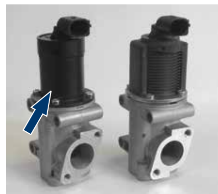
Figura 5: Il corpo bobina originale è stato sostituito da una semplice parte girevole (freccia).
