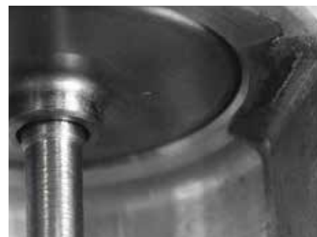
Figura 3: Una sede della valvola non a tenuta (freccia) causa problemi.
