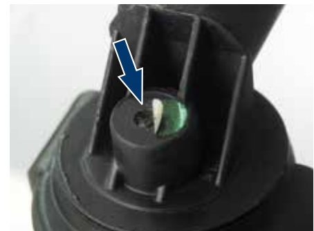
Figura 2: Questo foro (freccia) può causare la penetrazione di acqua e l'avaria.
