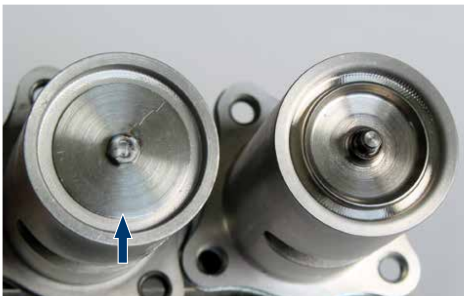
Figura 4: Un disco in lamiera saldato (freccia) non è un ricambio per una sede della valvola.
