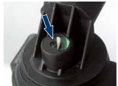
Photo 2 : ce perçage (flèche) peut laisser entrer l'eau et être source de panne.
