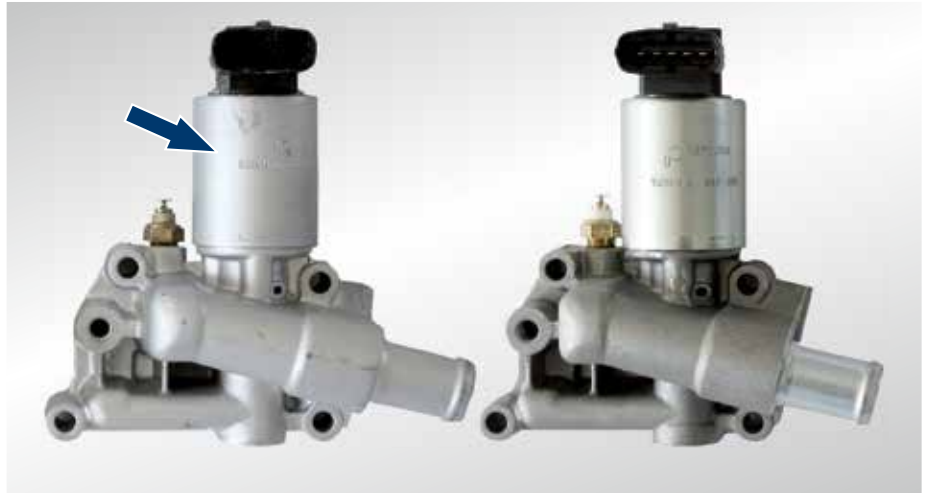
Photo 1 : une vanne EGR peinte (flèche) ; elle a l'aspect du neuf mais ne l'est pas.
