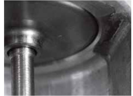
Photo 3 : un siège de soupape non étanche (photo) occasionne des problèmes.
