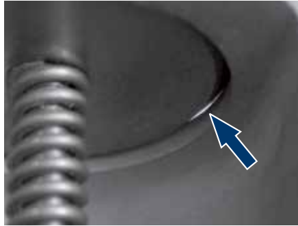
Photo 3 : un siège de soupape non étanche (photo) occasionne des problèmes.
