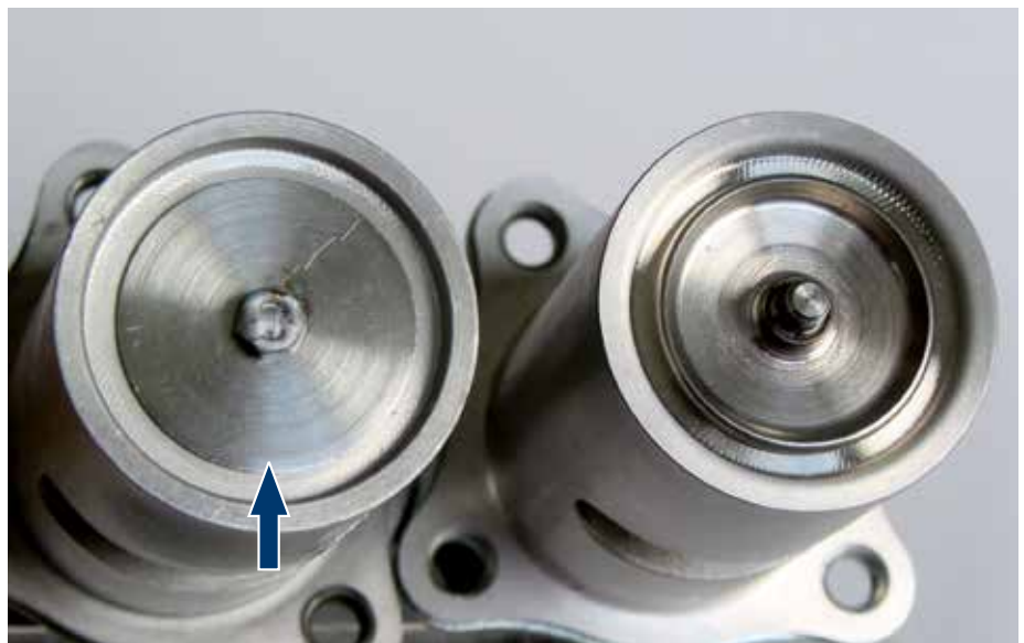
Photo 4 : une rondelle en tôle soudée (flèche) ne peut pas remplacer un siège de soupape.
