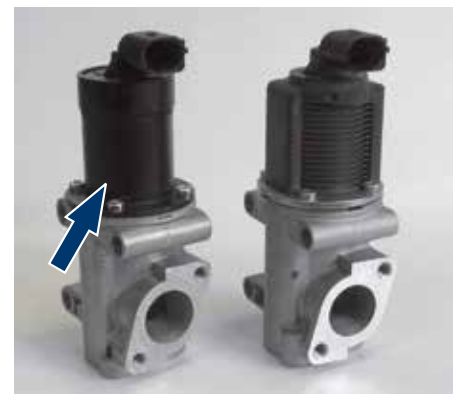
Photo 5 : le corps de bobine d'origine a été remplacé par une simple pièce tournée (flèche).
