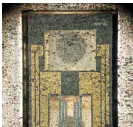
Il sale e lo sporco possono danneggiare il sensore di un sensore della massa d'aria, o per lo meno falsificare le misurazioni, cosa che può agire sull'EGR.
