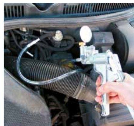
Il funzionamento delle valvole EGR pneumatiche o, come in questo caso, di un EPW: può essere facilmente controllato con una pompa di depressione manuale.
