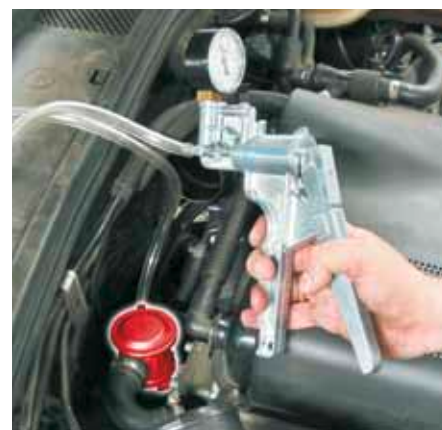
Kontrola zaworu powietrza wtórnego za pomocą ręcznej pompki podciśnienia
