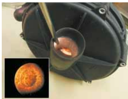
Skorodowany wlot pompy powietrza wtórnego
