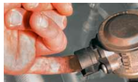
„Próba palcowa” zaworu powietrza wtórnego (wyróżniony) w BMW 520i. Jeżeli po tej stronie występują osady, oznacza to, że zawór zwrotny jest nieszczelny i należy go wymienić.
