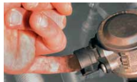
„Kontrola prstem“ u ventilu sekundárního vzduchu ve vozidle BMW 520i (zvýrazněno) Pokud se na této straně nachází nánosy, pak je zpětný ventil netěsný a musí být obnoven.
