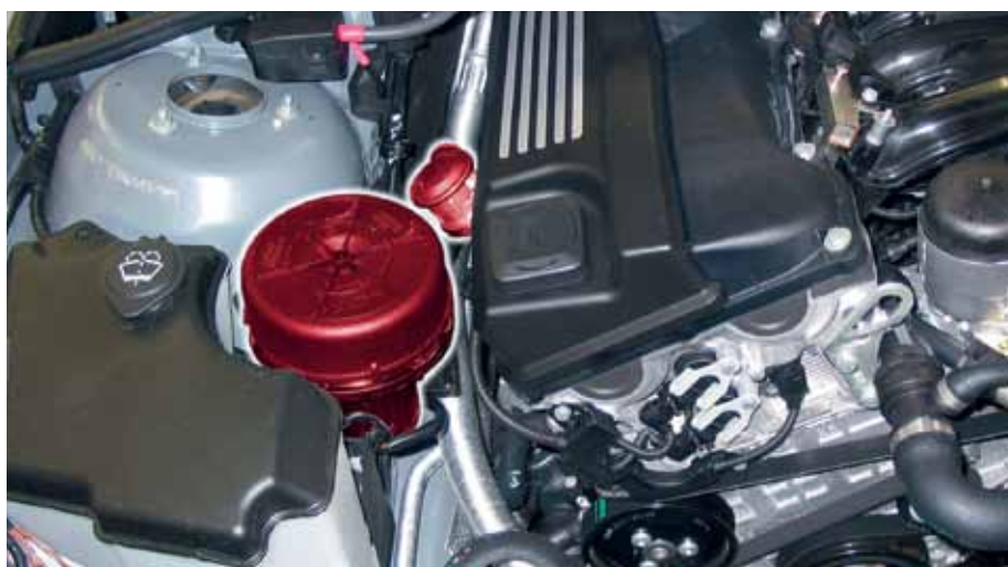
Ventil sekundárního vzduchu a čerpadlo sekundárního vzduchu ve vozidle BMW E46 (zvýrazněno)
