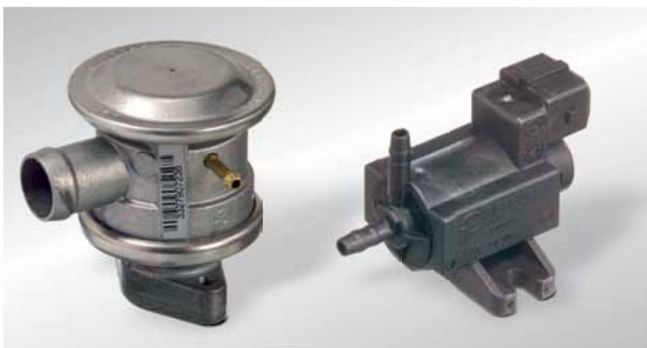
Podtlakově řízený odpojovací zpětný ventil (cca od roku 1995) a elektrický přepínací ventil
