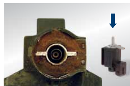
Zkorodovaný elektrický přepínací ventil (otevřený)
