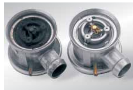
Otevřený ventil sekundárního vzduchu Vlevo: Škody způsobené kondzátem spalin Vpravo: Nový stav
