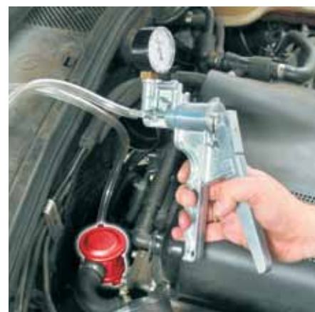
Kontrola ventilu sekundárního vzduchu pomocí podtlakové ruční pumpy
