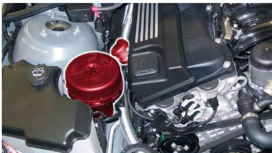
Клапан вторичного воздуха и насос вторичного воздуха в BMW E46 (выделено)
