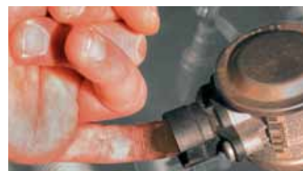
"Teste manual" efectuado à válvula de ar secundário num BMW 520i (em destaque) Se houver depósitos deste lado, significa isso que a válvula de retenção tem fugas e terá de ser substituída.
