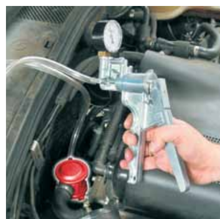
Verificação de uma válvula de ar secundário com uma bomba de vácuo manual
