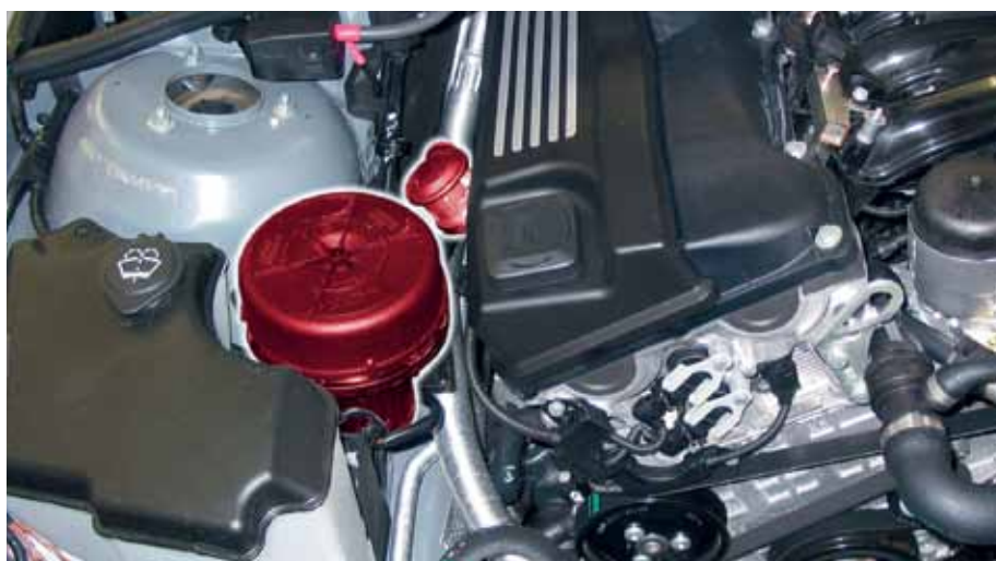
Válvula de ar secundário e bomba de ar secundário num BMW E46 (em destaque)
