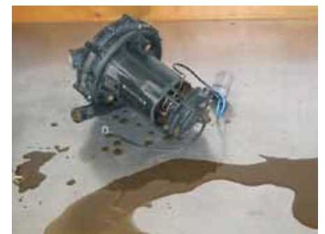
Condensação de gases de escape líquida de uma bomba de ar secundário
