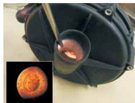
Vista da entrada corroída de uma bomba de ar secundário
