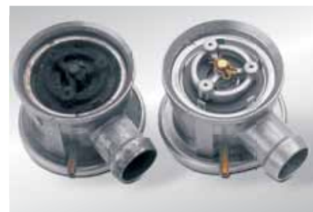
Válvula de ar secundário aberta esquerda: danos provocados por condensação de gases de escape direita: estado novo
