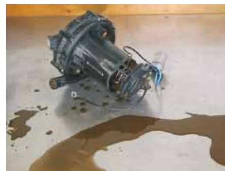
Flydende røggaskondensat fra en sekundærluftpumpe
