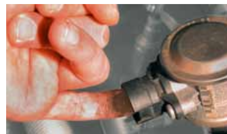
»Fingerprøve« på sekundærluftventil i BMW 520i (fremhævet) Hvis der på denne side er aflejringer, er kontraventilen utæt og skal udskiftes.
