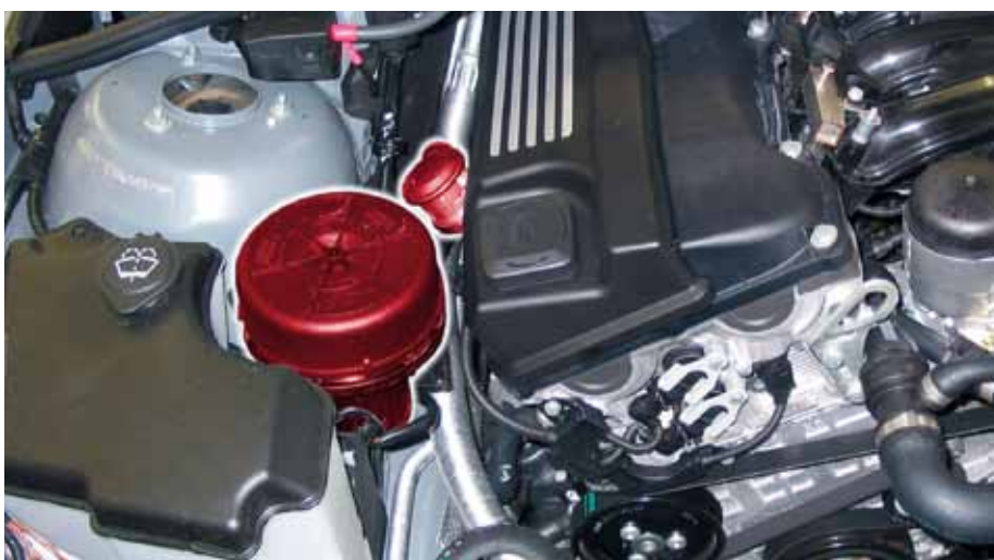
Sekundærluftventil og sekundærluftpumpe i BMW E46 (fremhævet)
