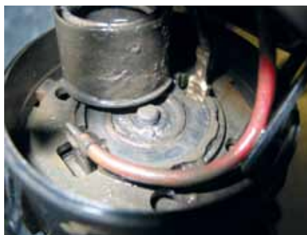
Aggressivt røggaskondensat i en sekundærluftpumpes drivmotor
