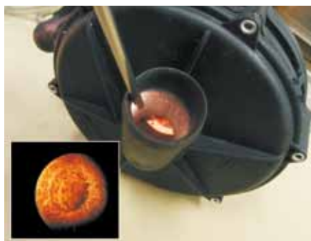
Blik ind i en sekundærluftpumpes korroderede indløb
