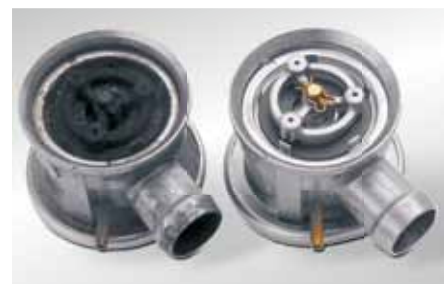
Åben sekundærluftventil Venstre: Skader pga. røggaskondensat Højre: Ny tilstand
