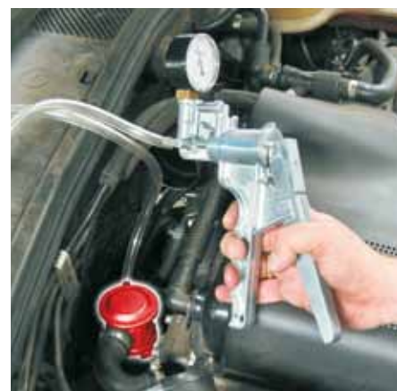
Kontrol af en sekundærluftventil med en håndpumpe for undertryk
