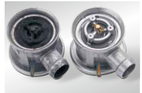
Válvula de aire secundario abierta izquierda: daños por condensado de gases de escape derecho: estado nuevo
