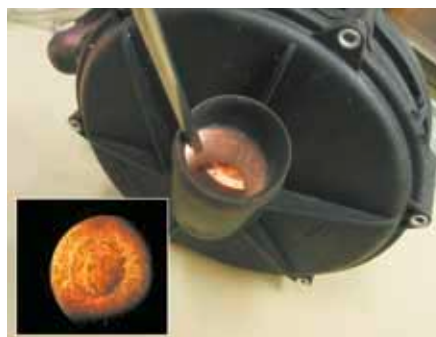
Vista en la entrada corroída de una bomba de aire secundario
