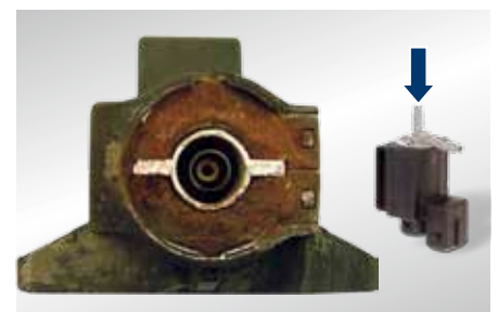
Válvula de conmutación eléctrica corroída (abierta)
