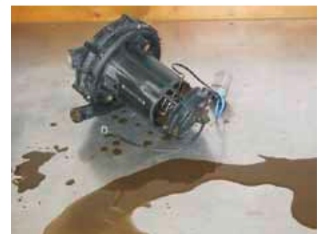
Condensado de gases de escape líquido de una bomba de aire secundario
