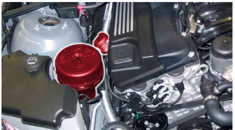
Válvula de aire secundario y bomba de aire secundario en el BMW E46 (destacado)
