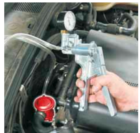
Comprobar una válvula de aire secundario con una bomba manual de depresión
