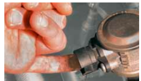
“Prueba del dedo” en la válvula de aire secundario en el BMW 520i (destacada) Si en este lado hay sedimentaciones, la válvula de retención es inestanca y se ha de renovar.
