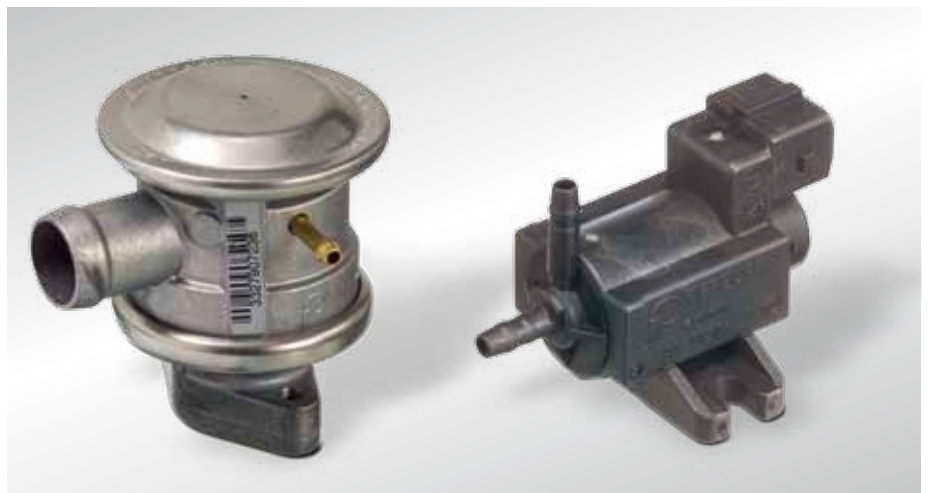
Válvula de retención y de corte controlada por depresión (desde aprox. 1995) y válvula eléctrica de conmutación
