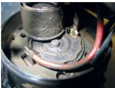
Condensado de gases de escape agresivo en el motor de accionamiento de una bomba de aire secundario
