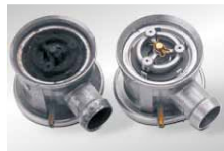
Valvola dell'aria secondaria aperta Lato sinistro: danni causati dalla condensa dei gas di scarico Lato destro: nuovo stato
