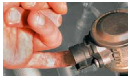
«Prova con il dito» sulla valvola dell'aria secondaria in BMW 520i (sottolineato) Se su questo lato sono presenti depositi, la valvola di non ritorno non è a tenuta e va sostituita.
