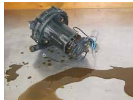
Condensa dei gas di scarico liquida da una pompa dell'aria secondaria
