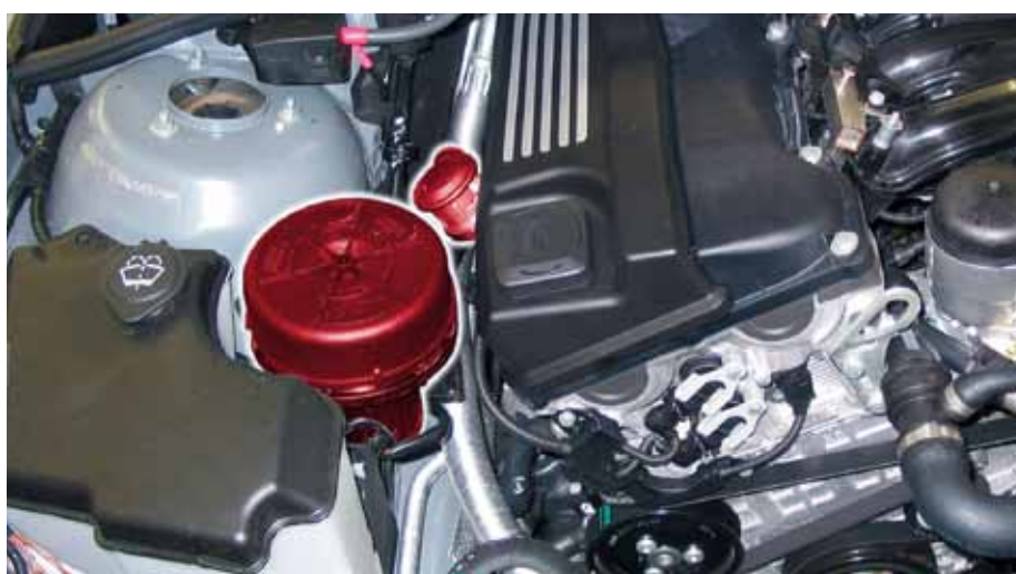
Valvola dell'aria secondaria e pompa dell'aria secondaria in BMW E46 (sottolineato)
