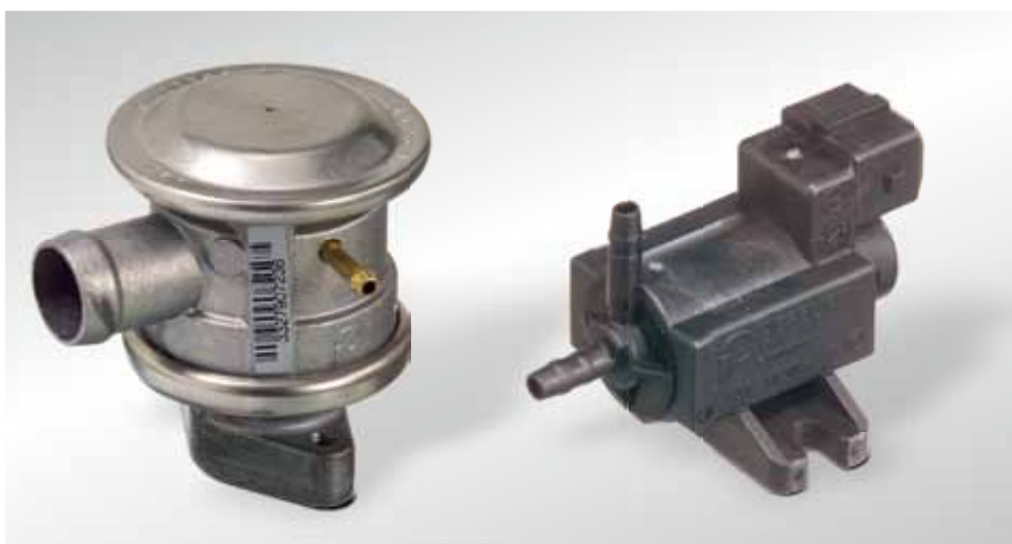
Valvola di non ritorno di disinserimento azionata con depressione (dal 1995 ca.) ed elettrovalvola di commutazione
