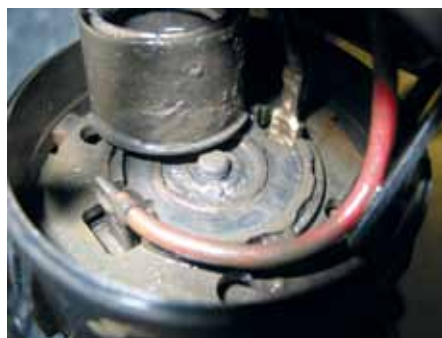
Condensa dei gas di scarico aggressiva nel motorino di azionamento di una pompa dell'aria secondaria
