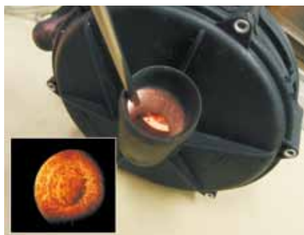
Sguardo nel bocchettone corrosivo di una pompa dell'aria secondaria
