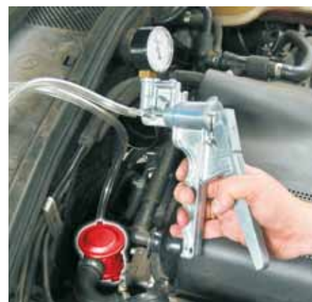
Controllo di una valvola dell'aria secondaria con pompa di depressione manuale
